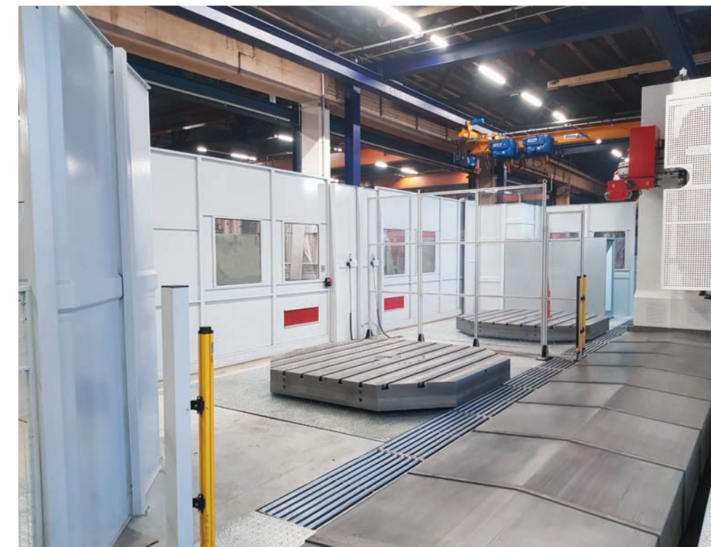
Ecomill S può essere completata con una tavola rotante
