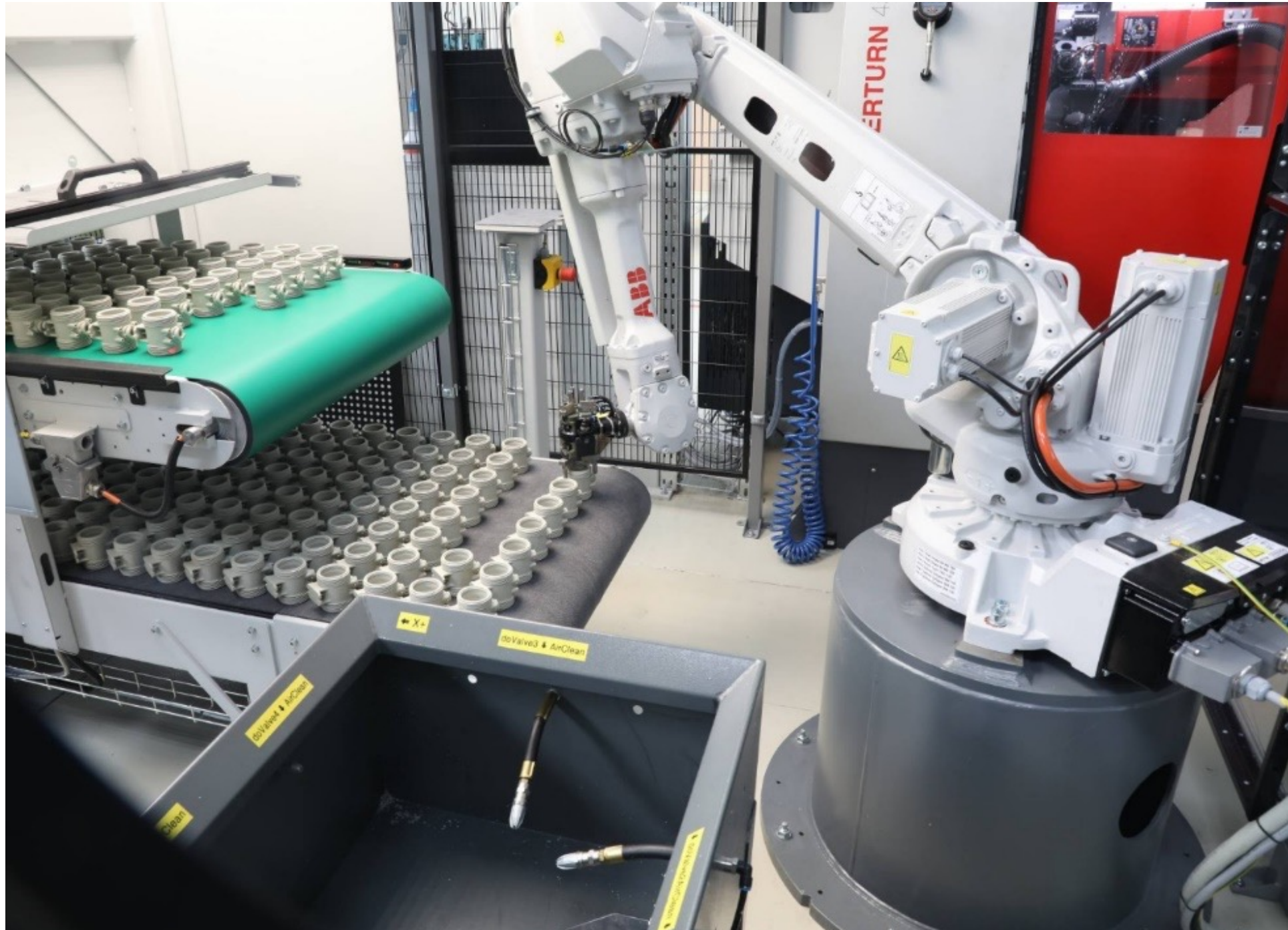
Das Bildverarbeitungssystem FlexLoader™ Vision von ABB ermittelt die Position der Bauteile. Die Koordinaten werden an den Roboter gesendet – die Komponenten können damit sicher vom Förderband aufgenommen und wieder abgelegt werden.
