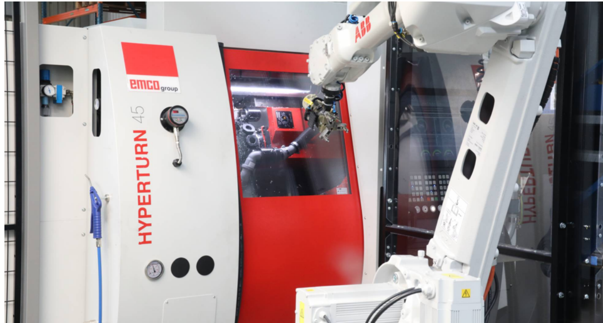
Dynamisches Duo: Bei Praher sorgt ein ABB-Roboter für hohe Spindellaufzeiten der Hyperturn 45 von Emco.
