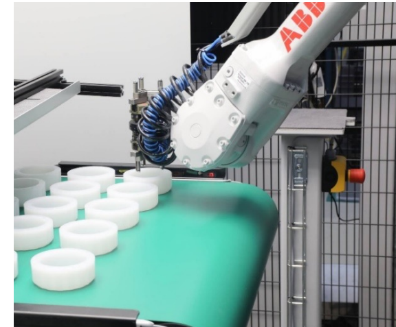
Bei Praher dient das grüne Förderband zur besseren optischen Wahrnehmung der Bauteillage.
