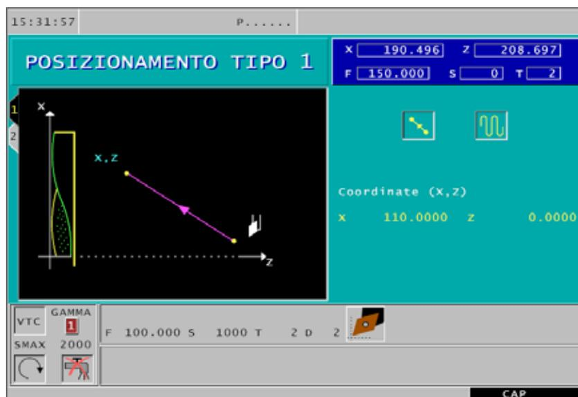
Con Posizionamento Tipo 1 si può traslare linearmente o posizionare l'utensile.
