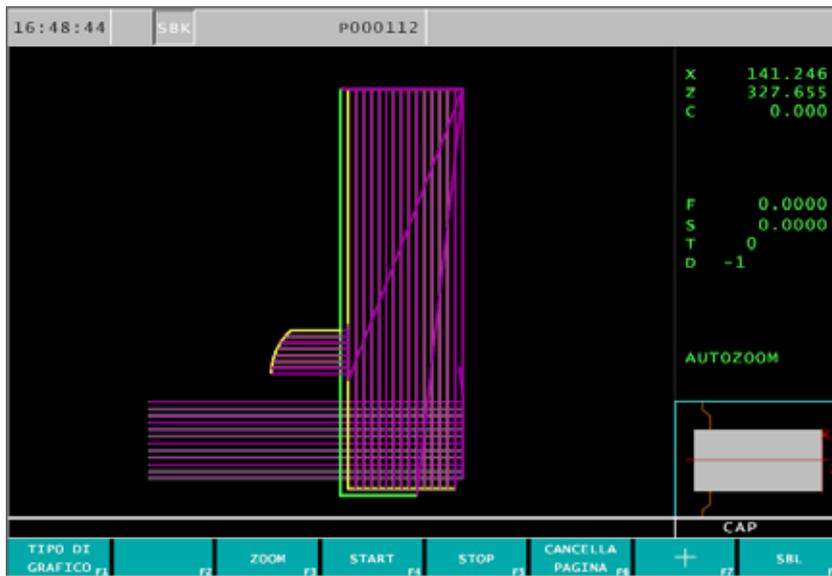
Con questa softkey la simulazione viene arrestata dopo ogni blocco. La simulazione può essere continuata ogni volta con
