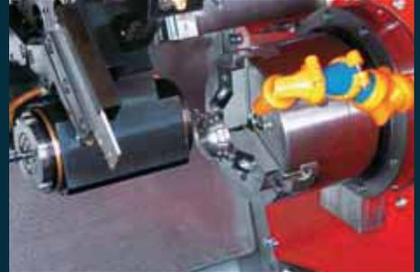
**Gegenspindel.** Auch hier sorgt ein 15 kW wassergekühlter Spindelmotor für hohe Dynamik und Präzision. Die Standardmaschine ist mit einem kühlmittel-durchflossenen Teileausstoßer ausgerüstet. Dieser stößt die fertigen Werkstücke in den Teilefänger und spült gleichzeitig die Spannfläche frei von Spänen. Zusätzlich ist oberhalb der Gegenspindel ein flexibler Kühlmittelschlauch zur Reinigung angebracht.
