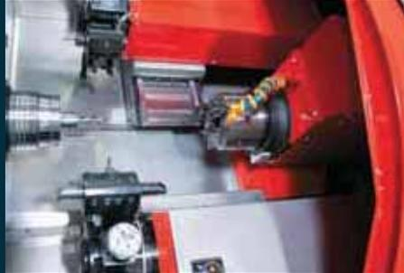
**Arbeitsraum.** Der großzügig gestaltete Arbeitsraum bietet Platz für viele Werkzeuge an beiden Revolvern und sorgt für kontinuierlichen Spänefluss auch bei mannarmer Fertigung. Zusätzliche Kühlmittelpumpen und ein ausgefeiltes Rohrsystem spülen die Späne in den Späneförderer.
