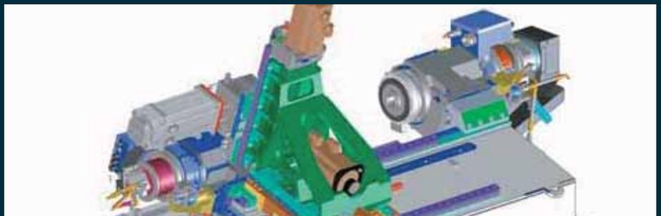
**Y-Achse.** Die Y-Achse ist im Grundmaschinenaufbau integriert und 90° zur X-Achse angestellt. Extrem kurze Auskraglängen bilden die Basis für solide Dreh- und Bohroperationen sowie für störkonturfreie Fräsoptionen.
