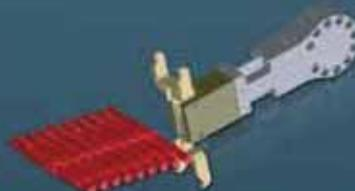
2-Finger-Kniehebelgreifer für die Beladung von Wellenteilen
