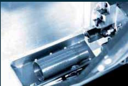
**Teilefänger.** Der pneumatisch betätigte Teilefänger in der HYPERTURN 45 wird über M-Funktionen angesteuert. Bei Bedarf fährt er in den Arbeitsbereich vor und schwenkt zur Spindelmitte. Das Fertigteil wird aus dem Spannmittel gestoßen und gelangt in die Auffangschale. Danach fährt der Teilefänger wieder in die Grundstellung, wo das Teil in eine Auffangbox oder auf ein Staubband gekippt wird.
