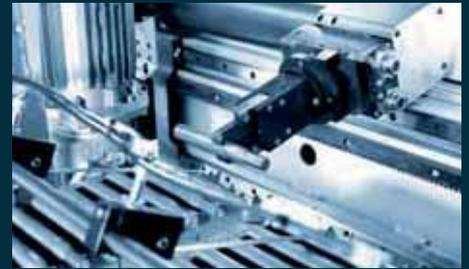
Taktförderband mit Prismenauflagen für unterschiedlich vorgeformte Wellenteile.
