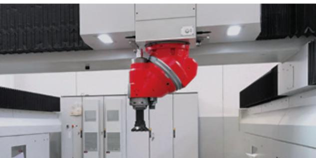
Carro dell'asse Z integrato nella traversa della macchina, la sua struttura garantisce i massimi risultati di rigidità e dinamica.
