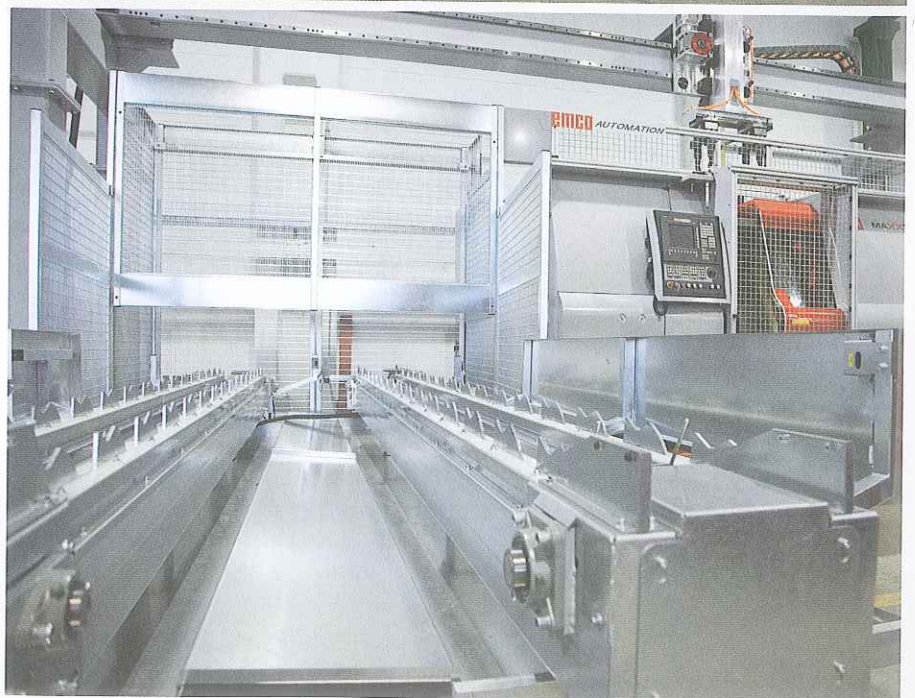
Handling-Portale von Güdel für Sany – hier am Drehzentrum Maxxturn 95.
