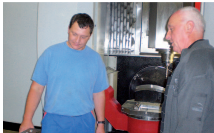
Schwenktisch. Der Schwenkrundtisch wird durch modernste Torque-Motoren gesteuert. Diese Technik garantiert hochpräzises Positionieren und Interpolieren über die gesamte Lebenszeit der Maschine, da im Unterschied zu Schneckengetrieben kein Verschleiß auftreten kann. Umkehrspiele oder Positionierhysterese sind zu 100% eliminiert. Die angeschlossene Wasserkühlung sorgt für konstante Temperatur auch bei hochdynamischen Anwendungen.
