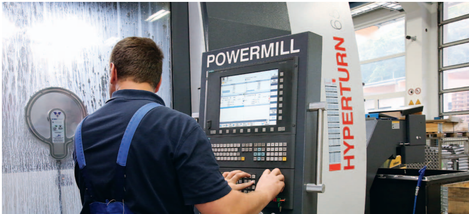
Die Hyperturn 65 Powermill punktet mit einer bedienerfreundlichen Ergonomie und guter Zugänglichkeit zum Arbeitsraum. Ein sehr großes Fenster eröffnet uneingeschränkte Sicht – das Werkzeugmagazin und die Steuerung befinden sich für den Bediener in unmittelbarer Reichweite.
