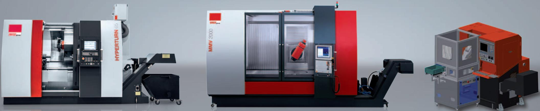
Im Bereich des Produktions-Drehen zeigt EMCO zwei neue Modelle aus dem sogenannten 65-iger Baukasten. Diese ergänzen die bestehenden Modelle, HYPERTURN 65-1300 DUOTURN/TRIPLETURN und POWERMILL. Neu im Programm ist die **HYPERTURN 65-1000** und **MAXXTURN 65-1000**, mit 65er, 75er und 95er Stangenkapazität, leistungsstärkerer Gegenspindel sowie Y-Achse in sämtlichen Werkzeugschlitten.
