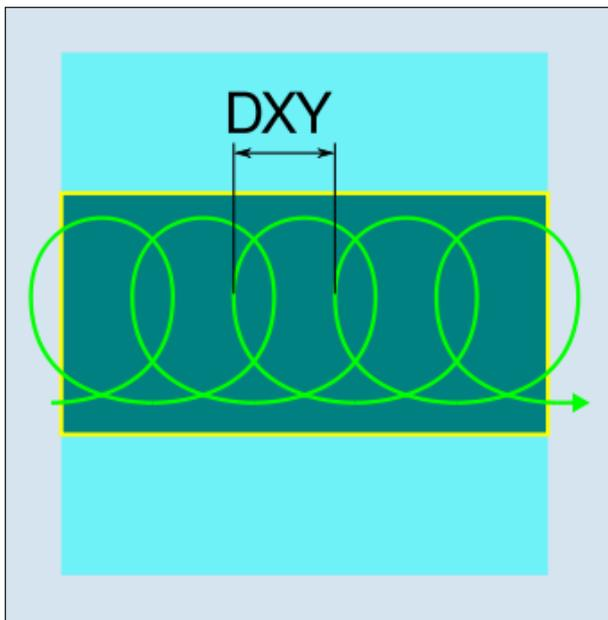
*Fresado torbellino sincrónico o asíncrono*
