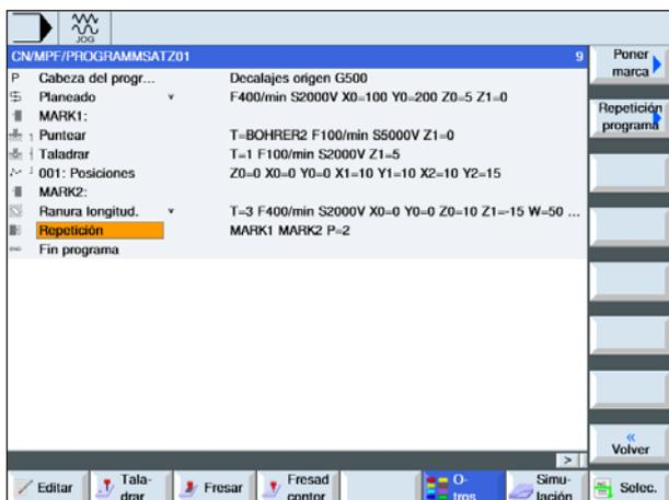
11 Las secuencias de programa entre la marca de inicio y la de fin se ejecutarán en la posición de la marca de repetición con las repeticiones programadas.
