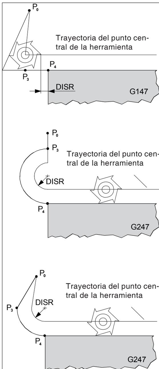
Movimiento de elevación y descenso representado con el punto intermedio  $P_3$  (con activación simultánea de la corrección del radio de la herramienta).
