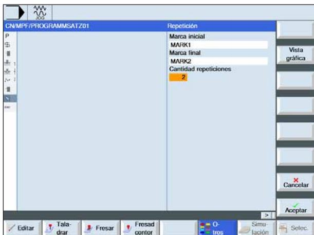
9 Pulsar la tecla multifuncional para colocar la marca de repetición. Indicar el nombre de la marca de inicio y el nombre de la marca de fin (p.ej.: MARK1 para la marca de inicio y MARK2 para la marca de fin). Definir la cantidad de repeticiones (p.ej.: 1).
