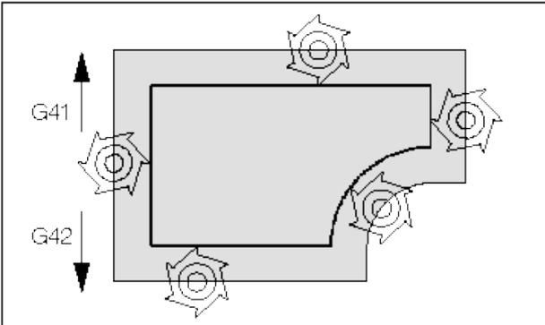
Con G41/42 la herramienta se desplaza una trayectoria equidistante al contorno programado. La distancia de la trayectoria corresponde al radio de la herramienta.
