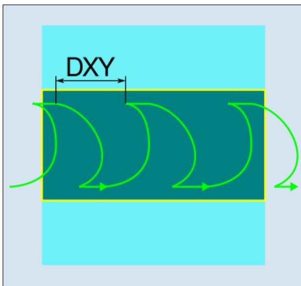
*Fresado torbellino sincrónico-asíncrono***3a Mecanizado ▽ desbastado**
