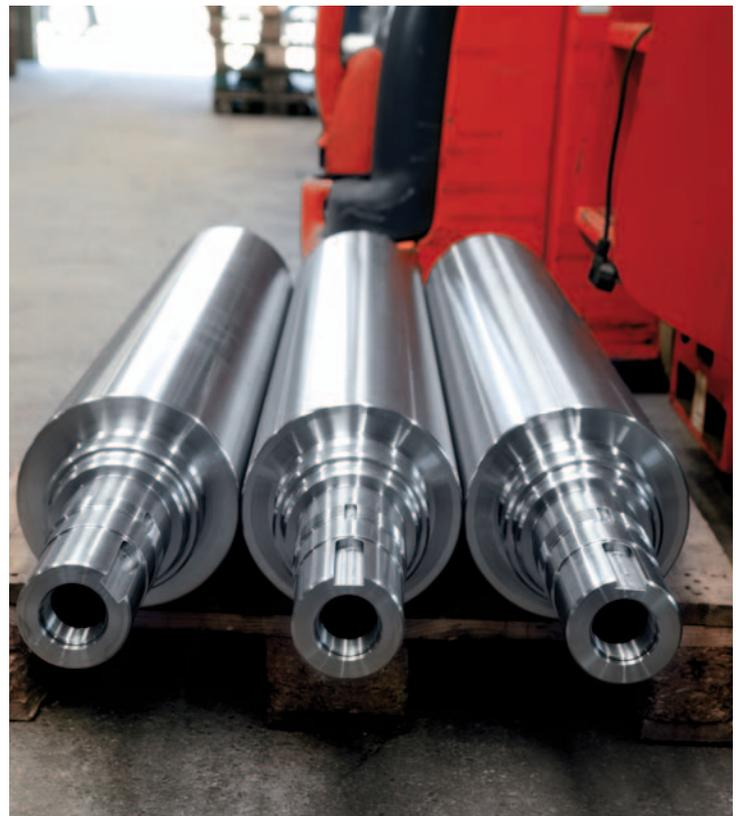
Die Antriebswellen aus hochwertigem legierten Stahl mit einem Durchmesser von 250 mm und einer Länge von 2500 mm sind komplett auf der Maxxturn 110 bearbeitet.
