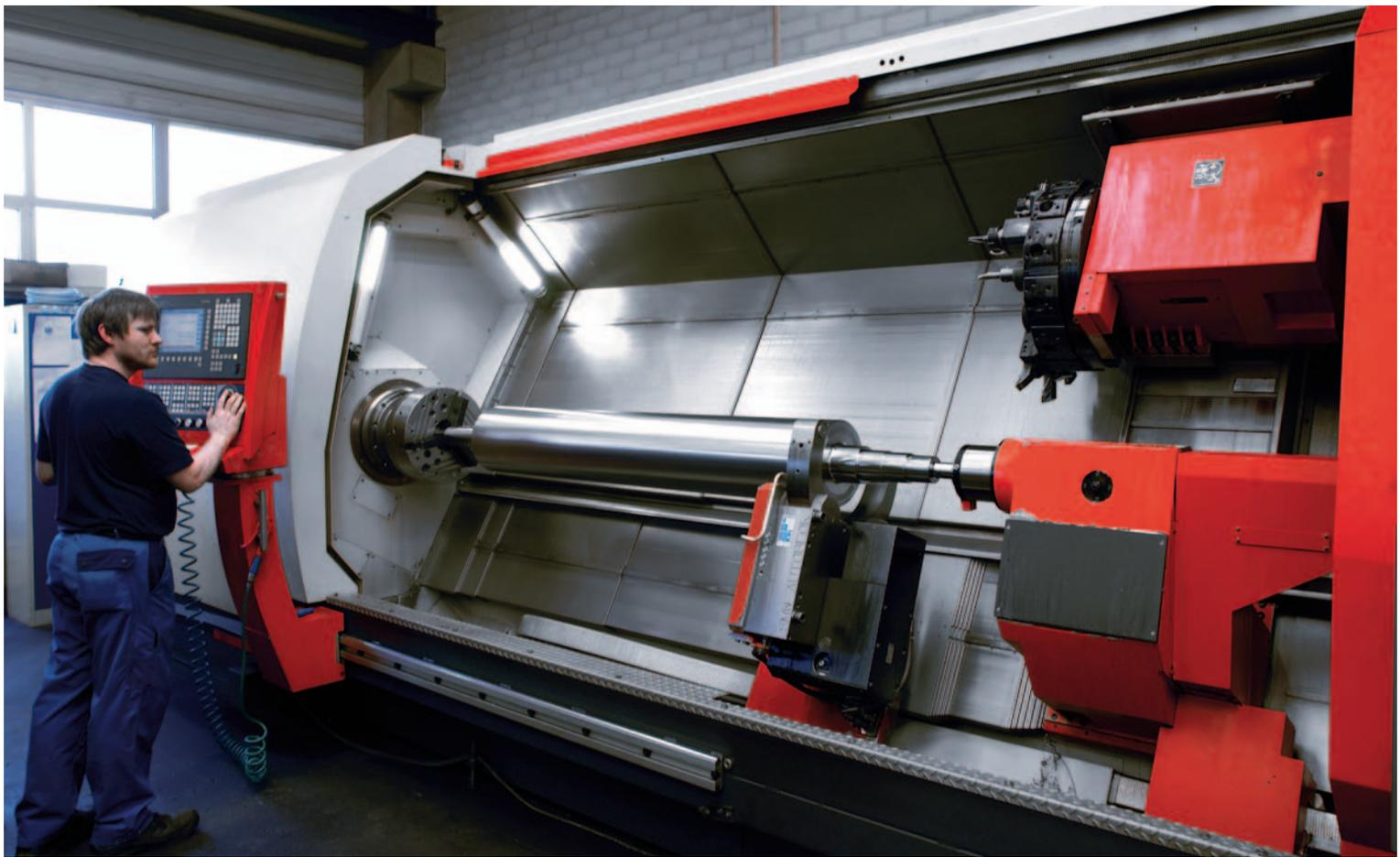
Die Maxxturn 110 x 3500 MY bearbeitet eine über 2000 mm lange Prägewalze mit 300 mm Durchmesser.
