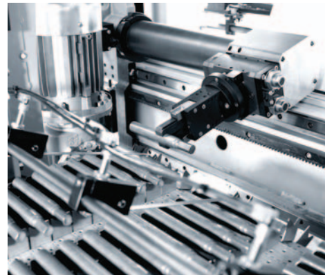
Taktförderband mit Prismenauflagen für unterschiedlich vorgeformte Wellenteile.
