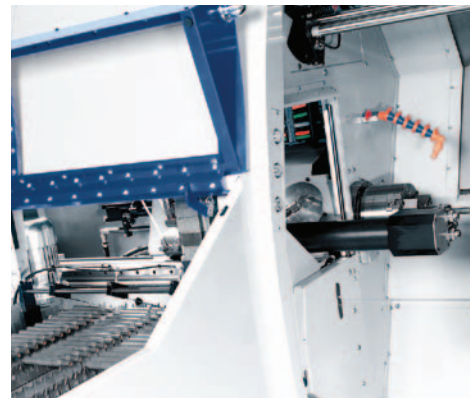
Vollautomatische Beladung von Wellen. Zuführung über Taktband, Abführung über die Fertigteilauflagevorrichtung.
