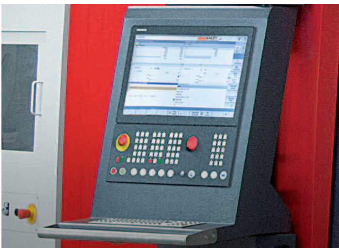
Hardwarebasis - 22" Industrie-Touch-Bedieneinheit in Verbindung mit einem Industrie-PC (IPC)
