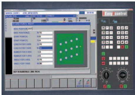
Der Wechsel auf eine andere Steuerung erfolgt durch Aufruf der entsprechenden Software und durch einfachen Austausch des steuerungsspezifischen Moduls innerhalb einer Minute.
