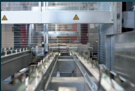
**Magazinierung:** Die Roh- und Fertigteile werden mit einem 2-spurigen Taktband automatisch zu- bzw. abgeführt. Das Band ist für eine Kapazität von 20 Teilen ausgelegt. Der Wellengreifer greift das beidseitig zentrierte Rohteil vom Taktband ab und bringt dieses in die Maschine. Die Magazinierung der Roh- und Fertigteile erfolgt identisch. Das Beladeportal ist für ein max. Werkstückgewicht von 150 kg ausgelegt.
