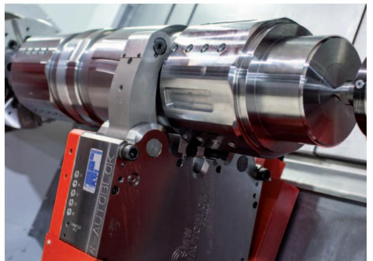
**Automatische Lünetten:** Selbstzentrierende Lünette mit hydraulischer Betätigung. Aufgebaut auf der Führungsbahn des Reitstockes und über Z-Schlitten schleppbar. Optional auch mit Servoantrieb verfahrbar (NC-Achse). Sperrluft, Zentralschmierung, Spülung sowie integrierte Spülkanäle an den Armen (optional) für eine oder mehrere Lünetteneinheiten oder Schlittensysteme verfügbar.
