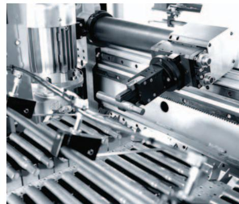
Taktförderband mit Prismenauflagen für unterschiedlich vorgeformte Wellenteile.
