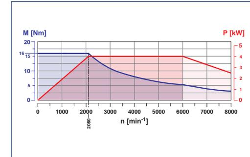
Kennlinie für angetriebene Werkzeuge
