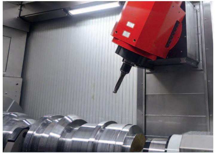
**Frässpindel.** Für stabile, präzise und flexible Bohr- und Fräsoperationen. Bis 80 kW und 630 Nm Drehmoment sowie 10.000 U/min. Sperrluft, HD-Kühlmittel intern bis 40 bar und extern bis 14 bar mit einem 1400 Liter Papierbandfilter serienmäßig (80 bar opt.). Mit der B-Achse kann in jedem beliebigen Winkel gearbeitet werden oder mit indexierter B-Achse im 2,5° Schritt.
