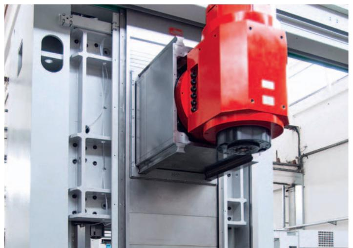
**Fahrständer.** Ist wie bei den Maschinen von EMCO MECOF in einer „Box-in-Box“-Ram-Konstruktion aufgebaut. Damit sind optimale Steifigkeit und Stabilität gewährleistet und eine hohe Genauigkeit bei der Bearbeitung umsetzbar. Die B-Achse ist mit Torque-Motor ausgestattet und in das Ram-Design integriert.
