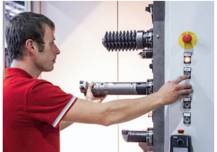
**Ergonomische Beladung** des Werkzeugmagazins mit Werkzeugen bis 25 kg und 600 mm Länge
