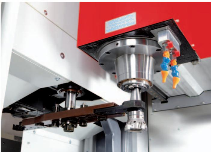
Mandrino ad elevata efficienza ISO 40 DIN 69871 / ISO 7388/2 tipo B. Opzione: ISO 40 DIN 69871 / DIN 69872, BT40, HSK63A (quest'ultimo solo con elettromandrino).
