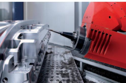
Lavorazione a 5 assi nonché fresatura, foratura, tornitura e filettatura fino a 15 ° in sottosquadro con le massime prestazioni in asportazione e precisione.
