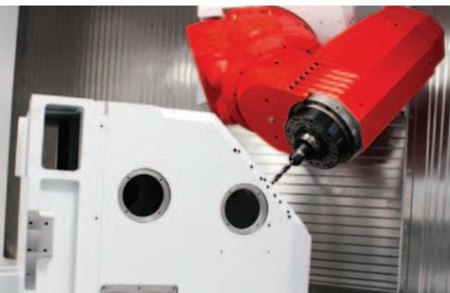
Fresatura, foratura e maschiatura su un carro porta testa.
