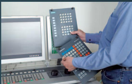
Il passaggio da un controllo ad un altro si fa in un minuto: richiamando con un tasto il rispettivo software e inserendo la tastiera del controllo scelto
