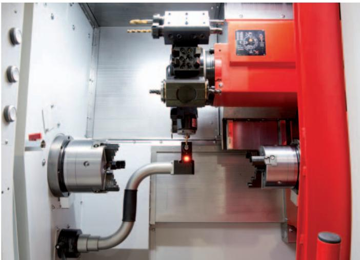
**Werkzeugvermessung.** Der optionale Werkzeugmessstaster im Arbeitsraum ermöglicht das schnelle und präzise Vermessen der Werkzeuge innerhalb der Maschine. Er wird händisch unterhalb der Hauptspindel montiert und nach Gebrauch wieder in eine Ablage an der linken Maschinenverkleidung abgelegt.
