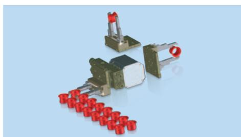
Parallelgreifer mit 180°-Drehmodul für die Beladung von Wellenteilen (1. und 2. Aufspannung)
