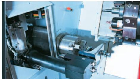
**Beladung des Rohteiles in die Hauptspindel.** Meist wird das Rohteil gegen einen Anschlag im Spannmittel positioniert und gespannt. Wellenteile können auch in ein Spann-zangenfutter oder zwischen Spitzen gespannt werden.
