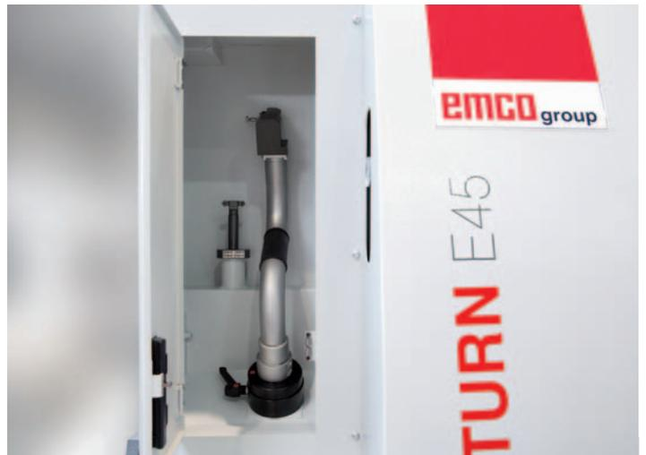
**Messtaster-Ablage.** Geschützter Ablagebereich für den Werkzeugmessarm und die Einstelllehre in der Seitenverkleidung der Maschine.
