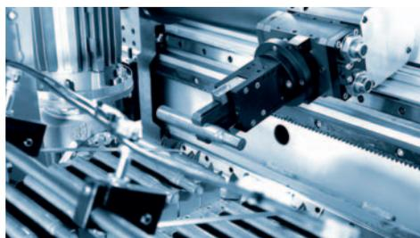
Taktförderband mit Prismenauflagen für unterschiedlich vorgeformte Wellenteile
