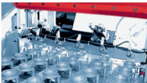
Taktförderband für die orientierte Rohteilzuführung mit großem Teilevorrat
