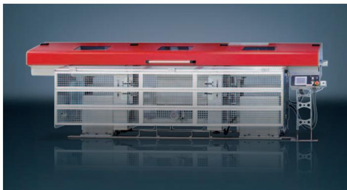
**EMCO TOP LOAD.** Zur vollautomatischen Beladung von 3-Meter Stangenmaterial in die Maschine. Mehrbahnige Materialauflagen ermöglichen einen noch längeren mannslosen Betrieb.
