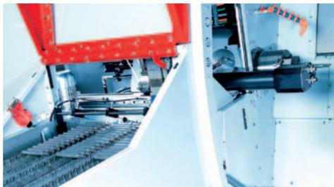
**Integrierter Schwenklader.** Der integrierte Schwenklader greift die Rohteile aus der Zuführung ab und fährt durch eine seitliche Öffnung in den Arbeitsraum der Maschine.
