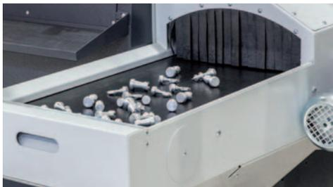
**Fertigteile.** Die Fertigteile werden größtenteils mit dem Teilefänger schonend auf ein Staubband abgelegt.
