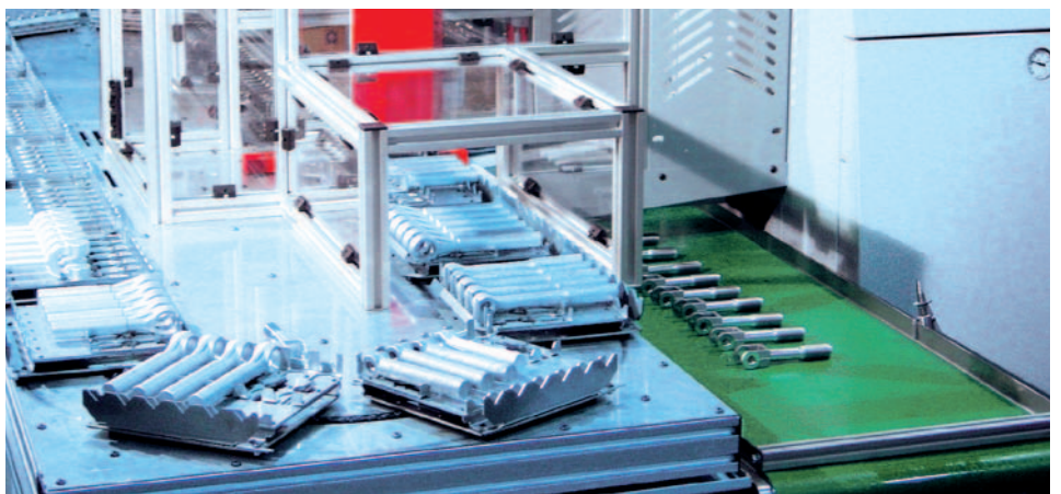
20-fach-Palettenmagazin mit kundenspezifischen Aufsatzpaletten
