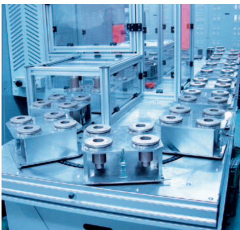
4-fach-Palettenaufsatz für Ventilkappen
