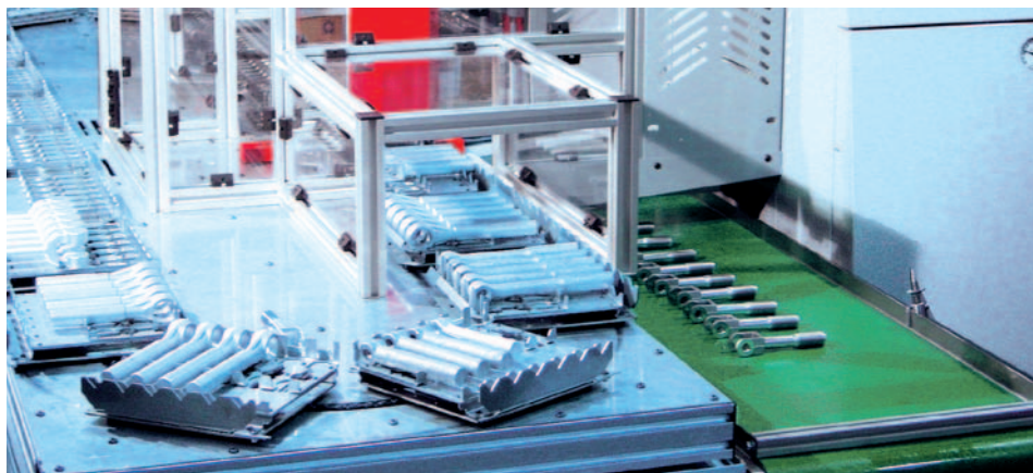
20-fach-Palettenmagazin mit kundenspezifischen Aufsatzpaletten
