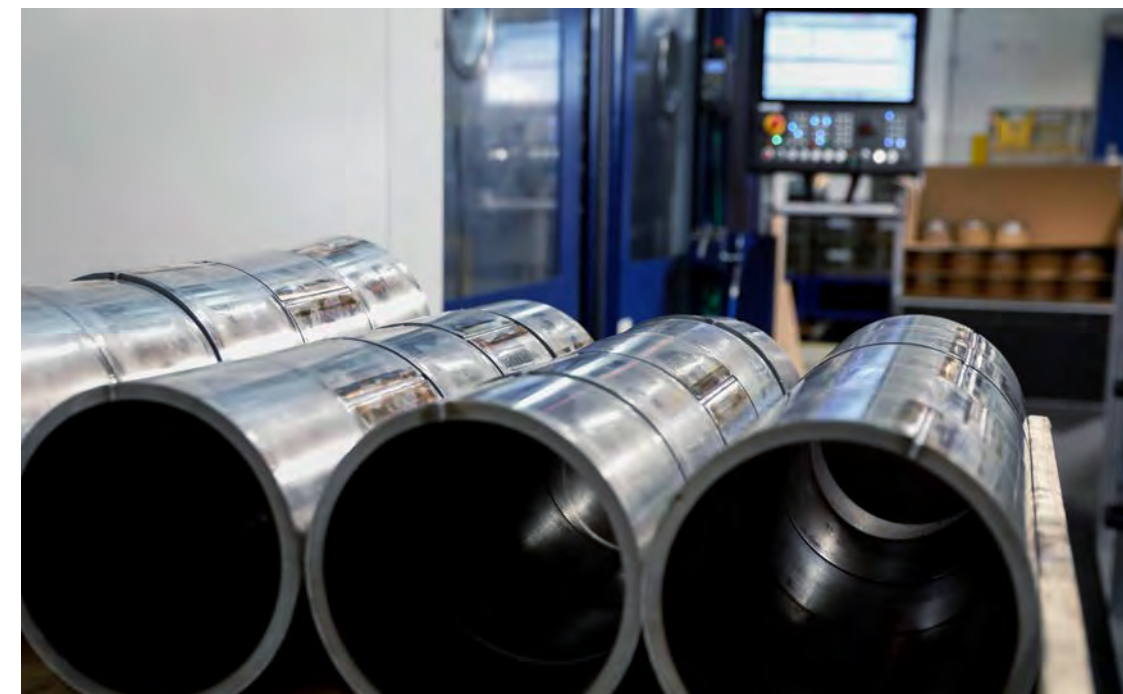
Le bocche a strisciamento sono realizzate in materiale composito e sono utilizzate in applicazioni con diametri da 125 a 500 mm.
