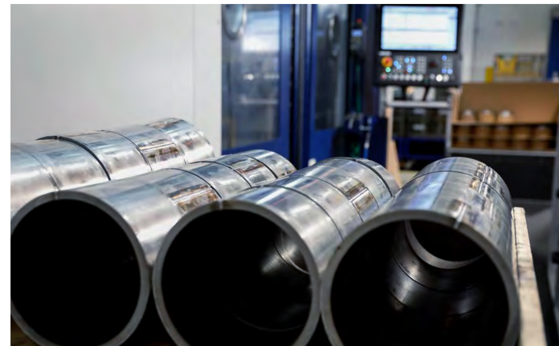
Les coussinets sont fabriqués dans un matériau composite et sont utilisés dans un domaine d'application de 125 à 500 mm de diamètres.
