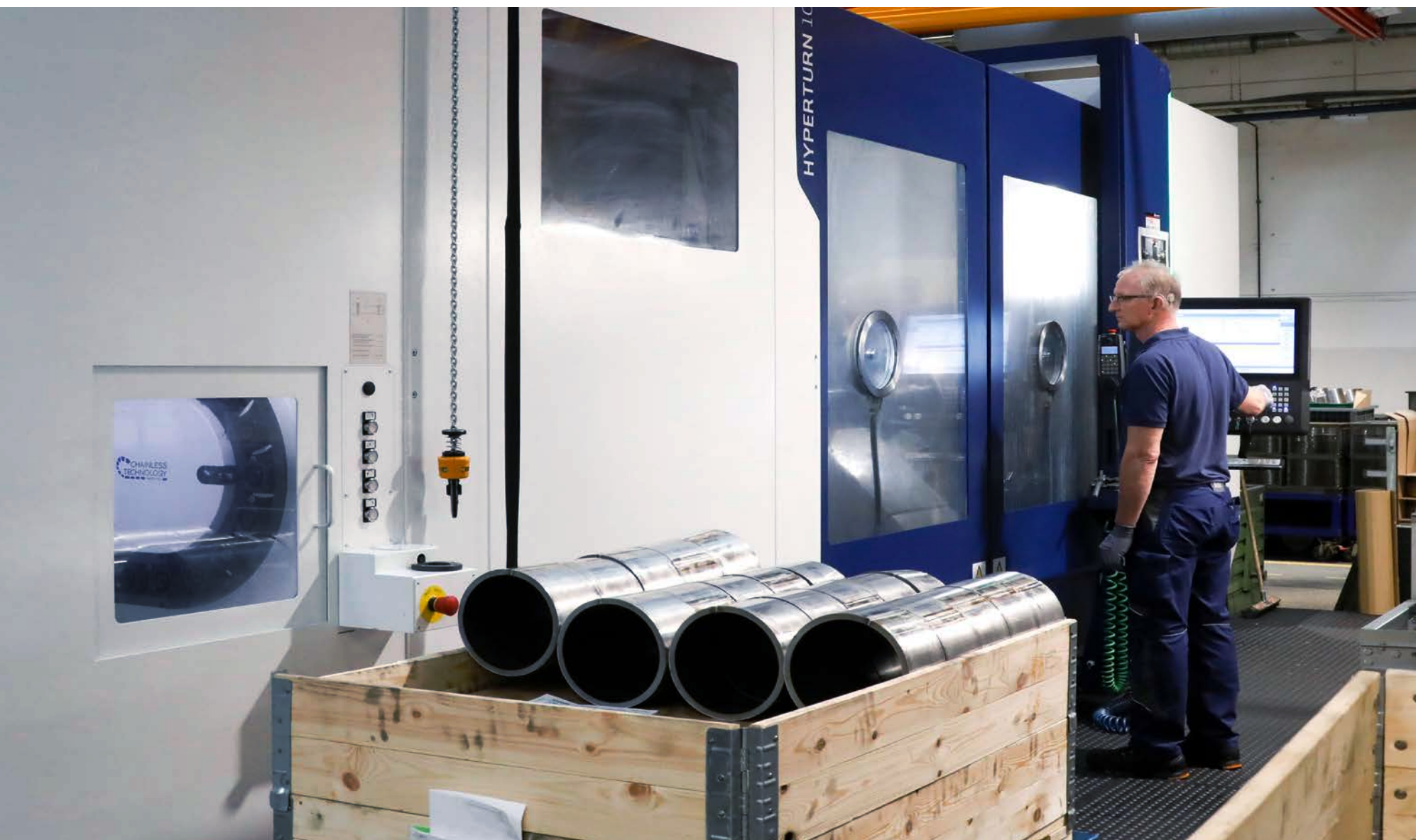
Centre de tournage et de fraisage HYPERTURN 100 Powermill pour l'usinage complet de pièces complexes.
