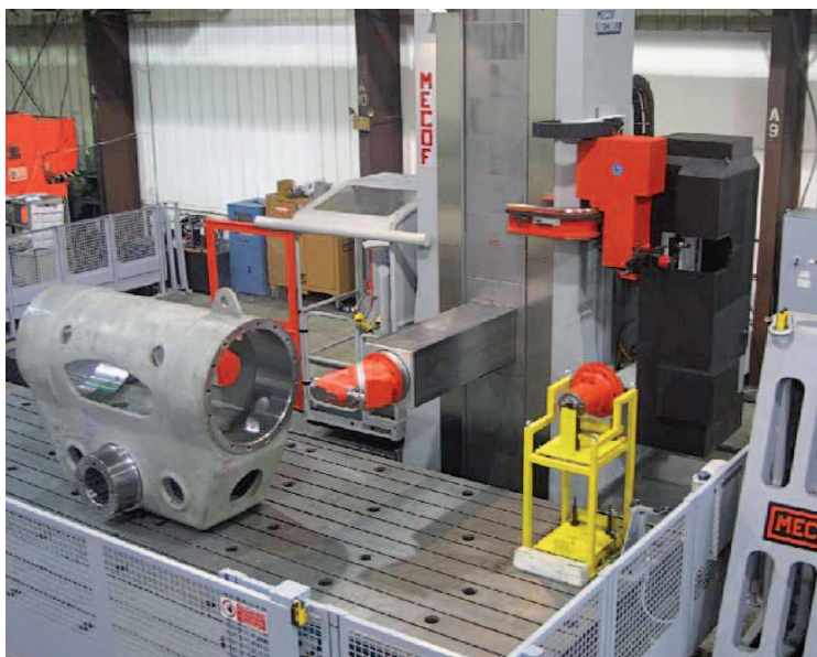
Energiesektor Bearbeitung eines Teils von Windkraftturbinen
