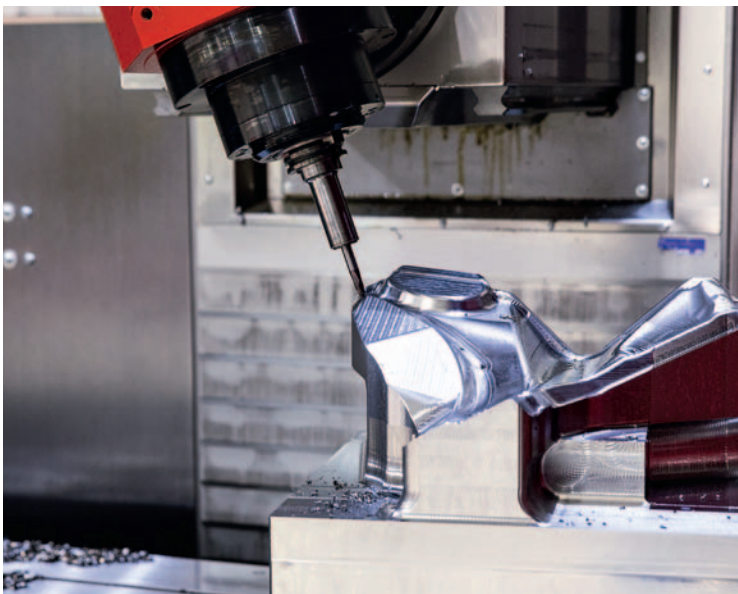
5-Achsen-Simultanbearbeitung mit 45° B-Achse (MMV 3200)
