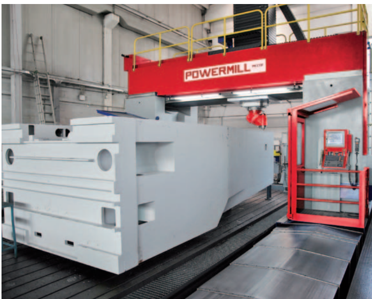
Allgemeiner Maschinenbau Bearbeitung eines großdimensionierten Werkzeugmaschinenständers
