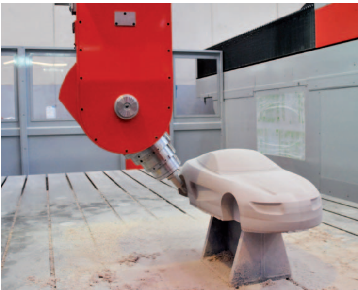
Automotive-Bereich Bearbeitung eines maßstabsgetreuen Modells aus Harz
