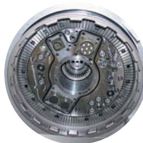
**Sistema di cambio teste completamente automatico**
