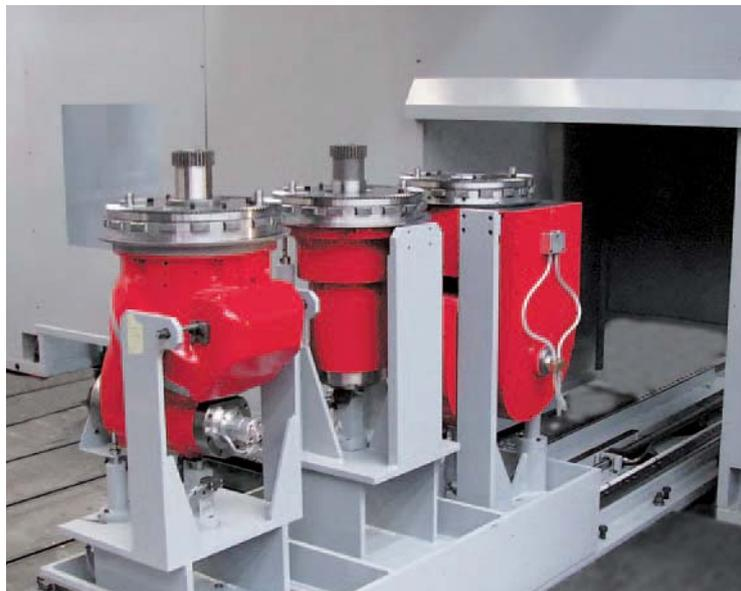
Il sistema di cambio teste totalmente automatico per i modelli di macchine verticali Linearmill, Dynamill e Megamill scompare totalmente dopo l'operazione di cambio teste, lasciando completamente libera l'area di lavoro.
