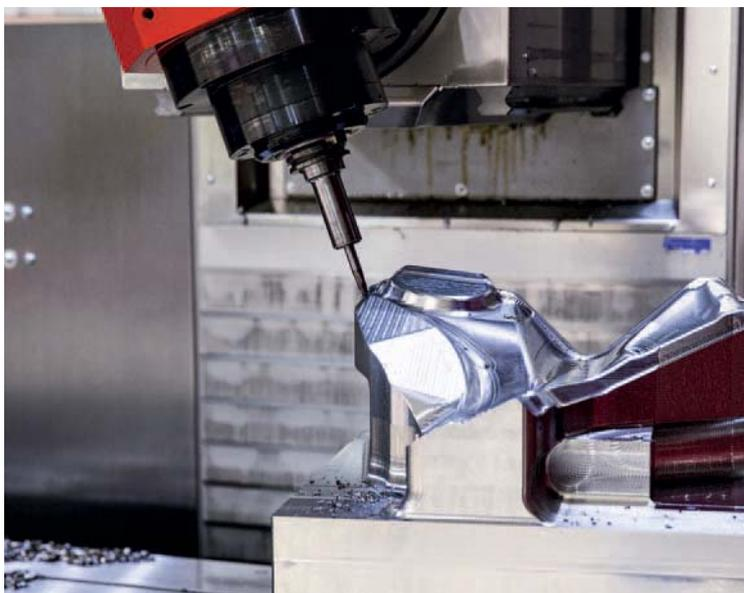
Lavorazione a 5 assi simultanei con asse B inclinato di 45° (MMV 3200)
