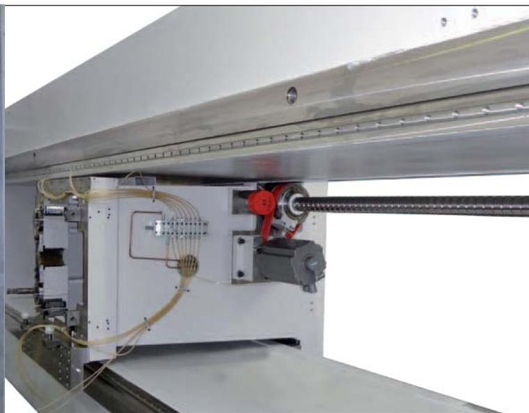
La struttura box-in-box offre una maggiore rigidità e un eccellente controllo delle derive termiche sia sulla linea orizzontale che su quella verticale.
