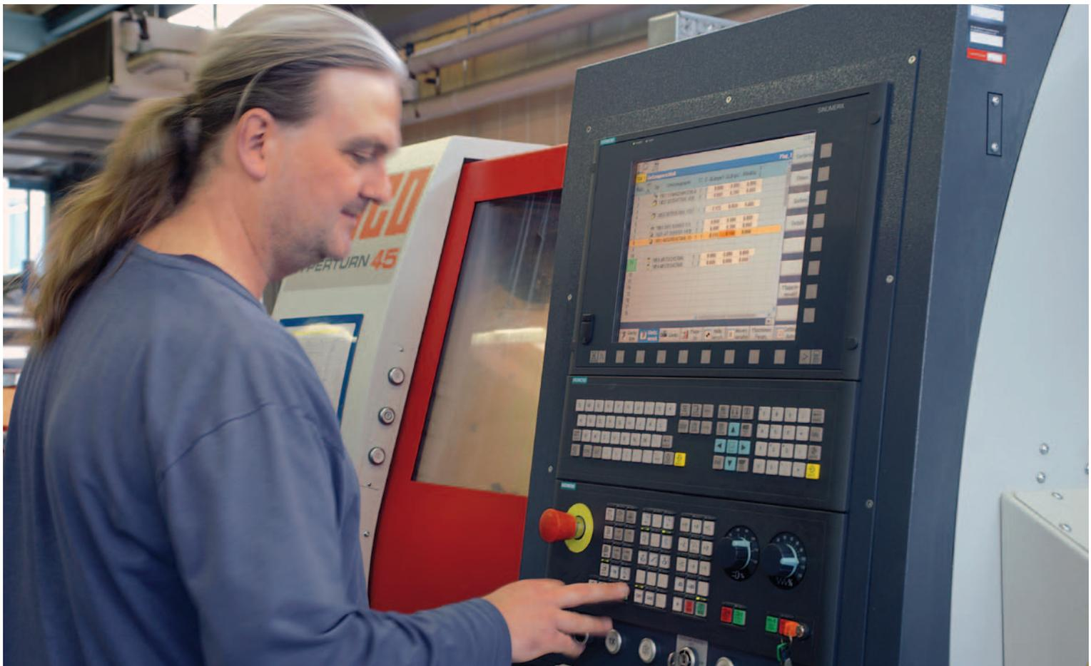
Die von Emco für DUNGS gestalteten Bedienoberflächen erleichtern den gleichmäßigen Fertigungsprozess, wie Matthias Hottinger an der Siemens Steuerung vorführt.
