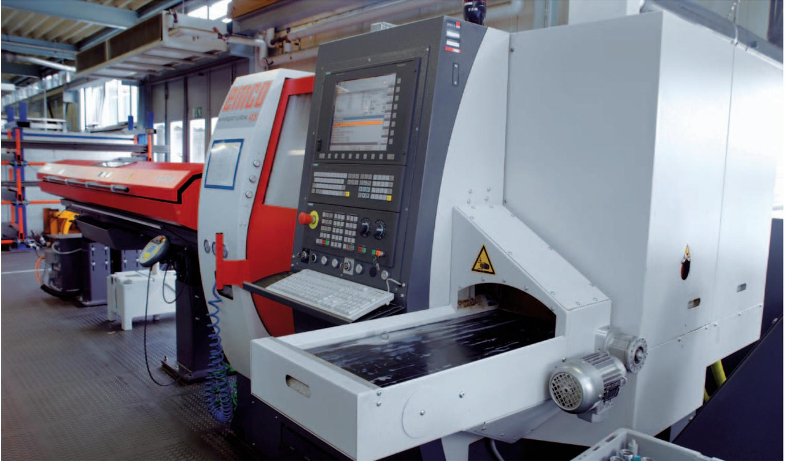
Der Turbo 5-55 lädt Stangenmaterial bis 65 mm Durchmesser vollautomatisch in die Hyperturn 45, die es mit den Werkzeugen im Revolver per Gegenspindel zu den fertigen Werkstücken bearbeitet.
