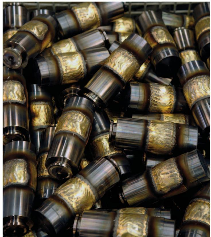
Dreiteilige Magnetschluss-hülsen, hier die hartgelöteten Vorprodukte, bearbeitet eine Hyperturn 45 per Aufbohren, Drehen und Gewindeschneiden – außen wie innen – zum Präzisionsteil.
