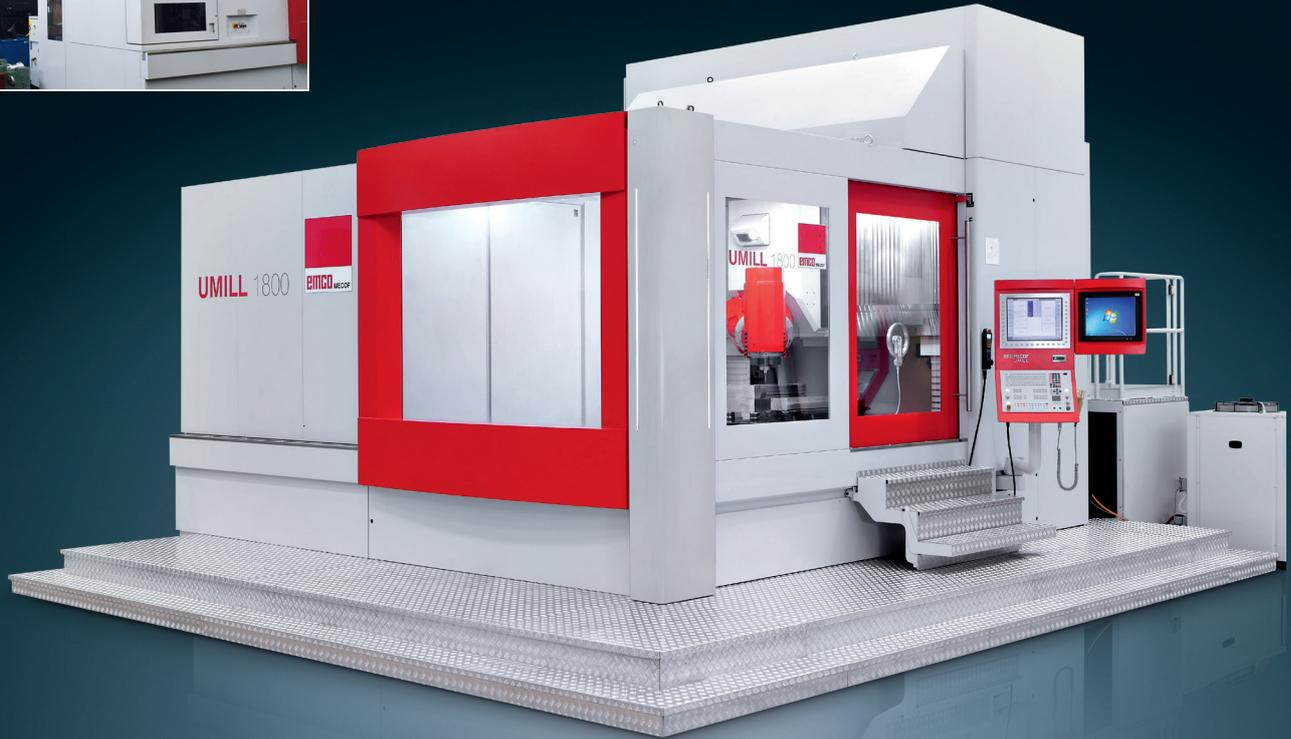
Portalfräsmaschine für die 5-Achs-Bearbeitung Umill 1800 im Einsatz beim Spritzgießwerkzeug-Hersteller HKR in Spraitbach
