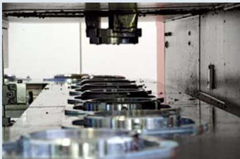
Das Spannfutter fährt im 1,2 Minuten-Takt aus der Arbeitsposition im Maschineninneren nach außen über das Schlepprahmenband, legt eine fertig bearbeitete Nutmutter ab und nimmt die nächste zu bearbeitende auf.
