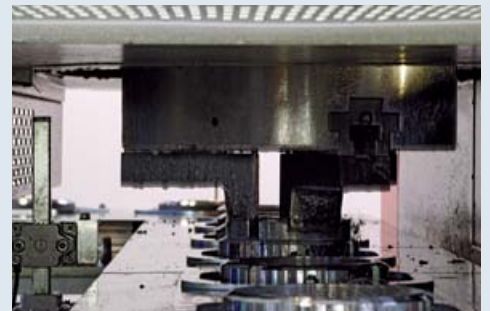
Das Spannfutter fährt im 1,2 Minuten-Takt aus der Arbeitsposition im Maschineninneren nach außen über das Schlepprahmenband, legt eine fertig bearbeitete Nutmutter ab und nimmt die nächste zu bearbeitende auf.
