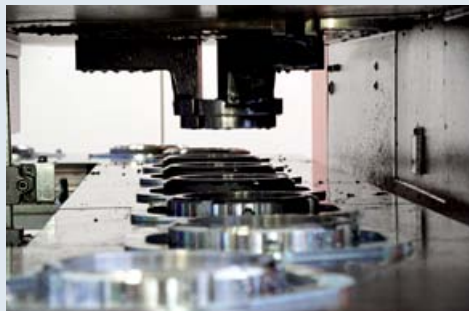
Das Spannfutter fährt im 1,2 Minuten-Takt aus der Arbeitsposition im Maschineninneren nach außen über das Schlepprahmenband, legt eine fertig bearbeitete Nutmutter ab und nimmt die nächste zu bearbeitende auf.
