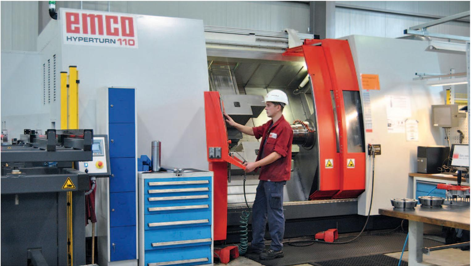
Haupt- und Gegenspindel der Hyperturn 110 verfügen über Hohlspannzylinder, sodass die bis zu 5000 mm langen Stangen ohne manuelle Eingriffe auf der ganzen Länge bearbeitet werden können.
