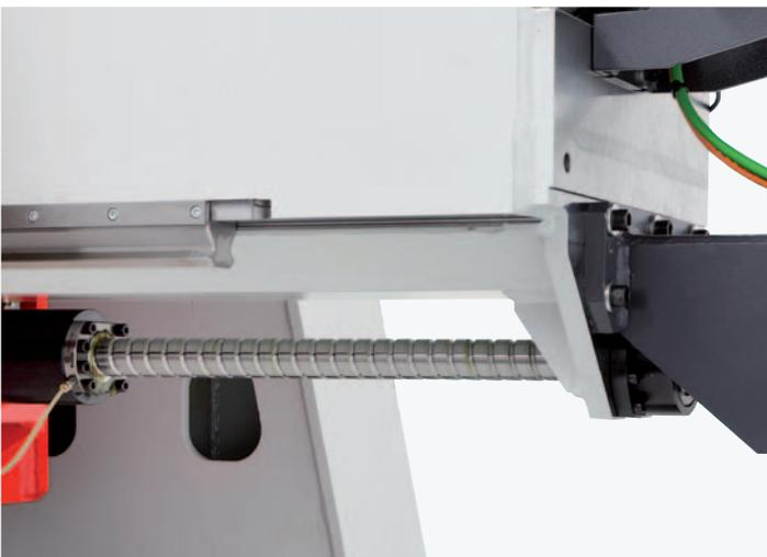
**Y-Achse:** Die Y-Achse ist als „Ram“ ausgeführt. Hier werden lange Führungsschuhe verwendet, um die notwendige Stabilität zu erreichen. Die hohe Präzision wird durch den Direktantriebsmotor an der Spindel garantiert.
