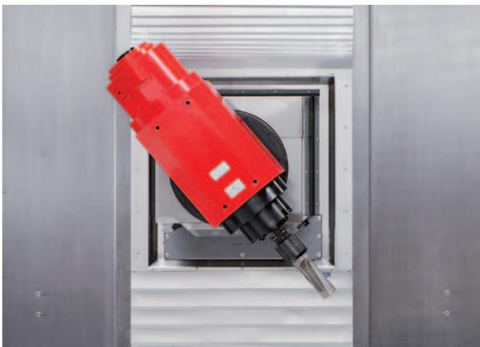
**B-Achse:** Die B-Achse wird von einem Torquemotor angetrieben und erreicht eine hohe Dynamik innerhalb des Schwenkbereichs von +/- 120 Grad.
