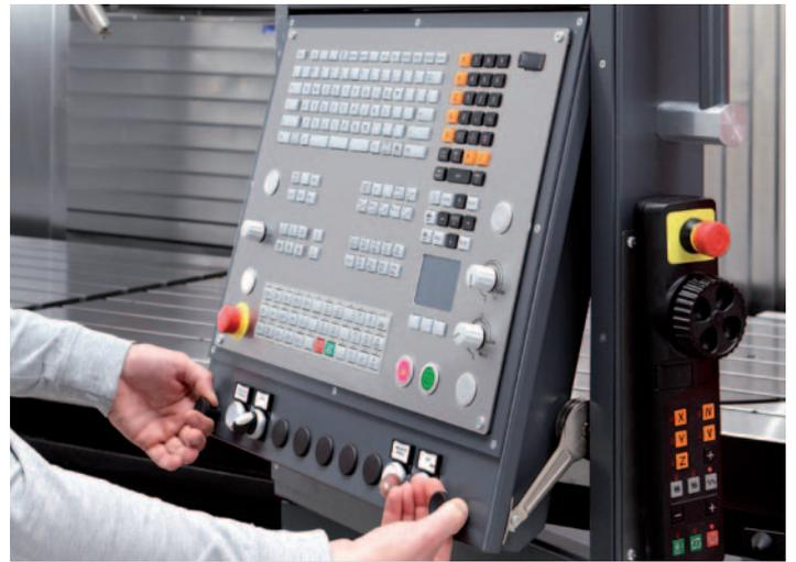
**Steuerung:** Das Bedienpult kann in Richtung des Arbeitsbereichs verfahren, gedreht und angepasst werden. Dieses ergonomische Design schafft ideale Arbeitsbedingungen für den Bediener.
