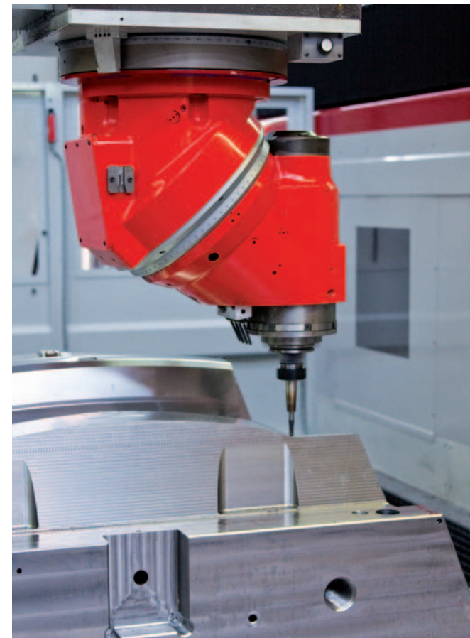
Hochgeschwindigkeitsbearbeitung von Spritzgussformen für Stoßfänger in der Automobilindustrie
