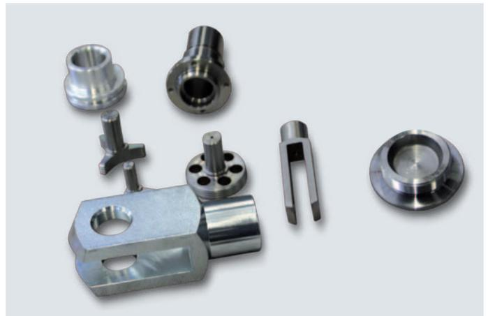
Auszug von Werkstücken, gefertigt mit der HYPERTURN 65 TRIPLETURN
