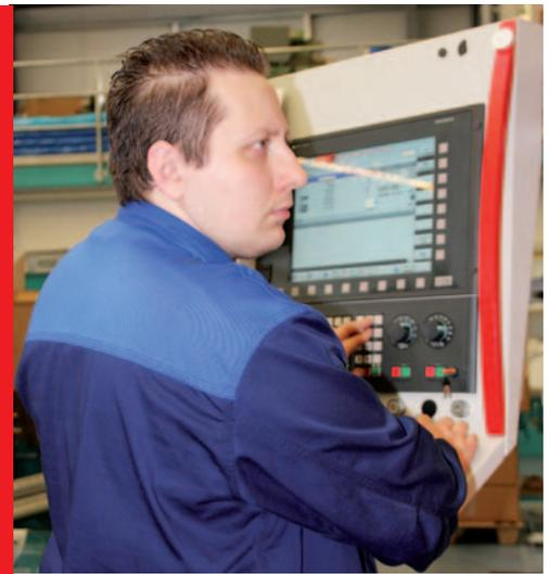
Ausziehbare Steuerung für optimale Ergonomie bei der Programmierung und beim Einfahren der Maschine.
