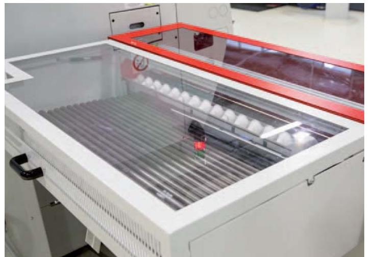
**Materialauflage.** Platzneutral hinten am Stangenlader angeordnet, befindet sich die Materialauflagefläche mit einer Länge von 560 mm. Entsprechend dem Durchmesser können unterschiedlich viele Kurzstangen magaziniert werden.
