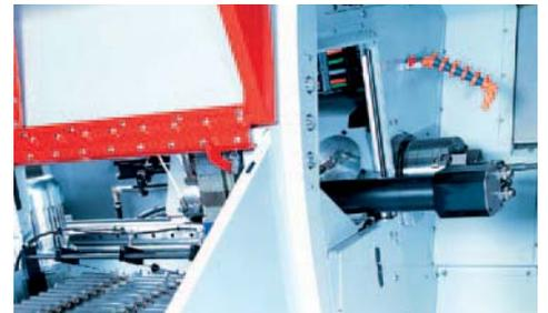
Vollautomatische Beladung von Wellen. Zuführung über Taktband, Abführung über die Fertigteilauflangvorrichtung.
