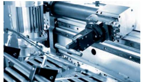
Taktförderband mit Prismenauflagen für unterschiedlich vorgeformte Wellenteile.
