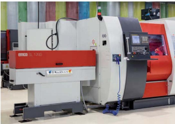
**EMCO SL1200.** Platzsparendes und kostengünstiges Stangenlademagazin. Einfachste Bedienung und Programmierung. Kann auch zur Beladung von Stückgut durch die Hauptspindel der Drehmaschine verwendet werden.
