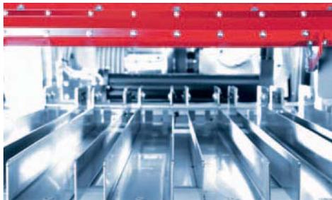
Mehrbahnige Zuführrinne für rotationssymmetrische Rohteile; die Rohteillänge bestimmt die Anzahl der Zuführrinnen.
