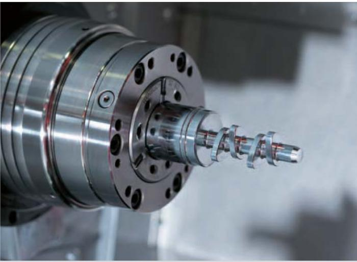
**Hauptspindel.** Die 15 kW Motorspindel sorgt mit integrierter Wasserkühlung für hohe Dynamik bei geringer thermischer Verlagerung. Ein hochauflösender Drehgeber bietet beste Voraussetzungen für die konturngenaue Fräs- und Bohrbearbeitung.
