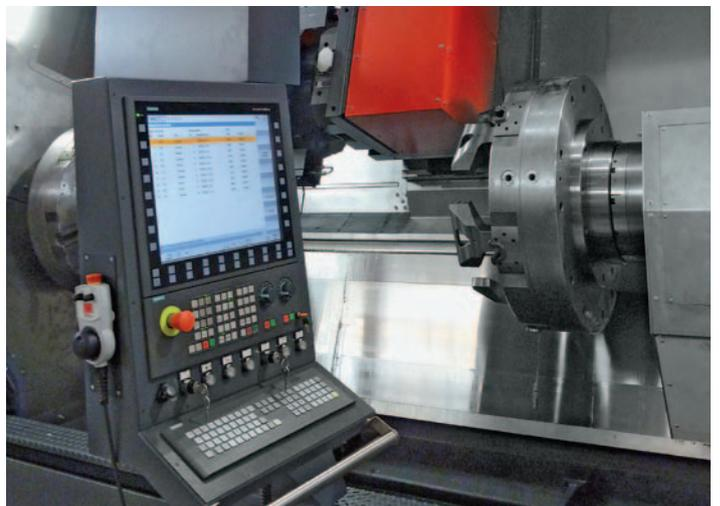
**Steuerung:** Die Maschine ist mit der Steuerung Siemens 840D sl ausgestattet. Zum Umfang gehören ein 22" Monitor mit neuester emcoCONNECT Bedienoberfläche sowie vielfältige EMCO Technologie-Zyklen (optional) für einfaches, dialoggestütztes Programmieren.
