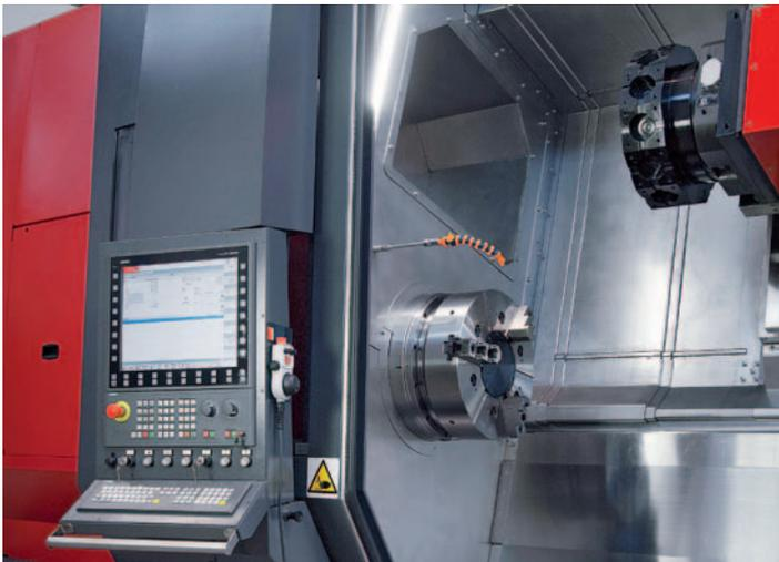
**Die Maxxturn 200** ist in einem modularen Baukastensystem mit Ausbaustufen vom einfachen Drehen bis zum Dreh-Fräszentrum mit vielfältigen Anwendungsmöglichkeiten aufgebaut. Dabei kommen verschiedene Spindelkonzepte mit C-Achse und hohem Drehmoment zum Einsatz.
