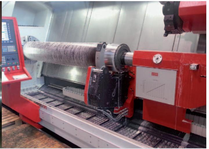
**Reitstock / Gegenspindel:** Die Maschine verfügt über einen NC-gesteuerten Reitstock (optional) mit integrierter Lagerung und MK6-Pinole für eine sichere und stabile Abstützung von Werkstücken bis zu einem maximalen Werkstückgewicht von 6 Tonnen. Mit der optional erhältlichen Gegenspindel können Werkstücke komplett in einem Arbeitsgang gefertigt bzw. zwei Werkstücke gleichzeitig bearbeitet werden.
