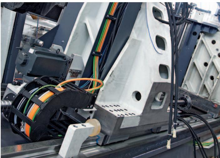
**Hochpräzise Y-Achsen:** Das Maxxturn Maschinenkonzept wurde speziell so entwickelt, dass die Y-Achse in einem Winkel von 90° aufgesetzt ist. Diese Y-Achse bietet durch breit aufgesetzte und bereits vorgespannte sowie großdimensionierte Führungsbahnen optimale Bearbeitungsergebnisse bei höchster Stabilität mit kurzen Auskräglängen; für bis zu zwei Revolver möglich.
