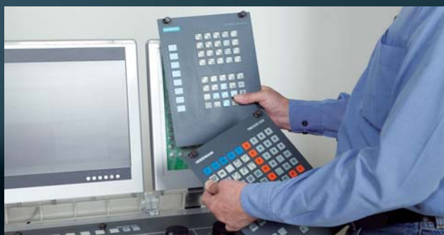
Con l'esclusivo concetto di controllo intercambiabile, per tutte le macchine Concept, l'operatore può essere addestrato all'utilizzo di tutti i controlli CNC industriali disponibili sul mercato.
