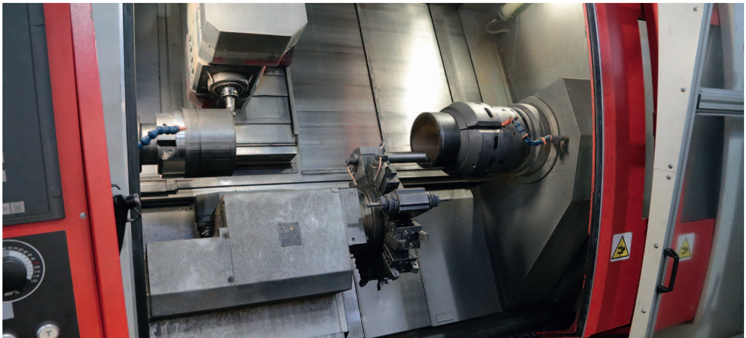
Der großzügige Arbeitsraum ist leicht zugänglich. Der Abstand von 1.700 mm zwischen den Spindelnasen erlaubt eine Simultanbearbeitung von zwei Teilen.
