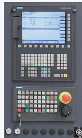
Die Steuerung ist bereits im Maschinengehäuse eingebaut, um die Außenmaße der Maschine so klein wie möglich zu halten.
