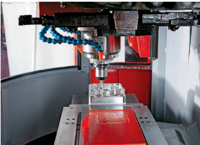
**Werkzeugwechsel:** Schnellwechsler mit Doppelgreifer und variabler Werkzeugplatzkodierung (random). Mechanische Spindel mit Hochleistungs-Spindeltrieb.
