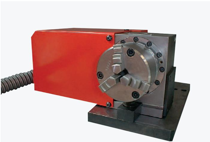
Als 4. Achse kann optional ein Rundtisch der Größe 80 oder 100 mm installiert werden. Der Rundtisch ist CNC-gesteuert und kann mit jeder linearen Achse (X,Y,Z) interpolieren.
