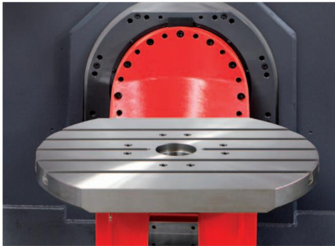
**Schwenkrundtisch.** Der Dreh-Schwenktisch hat eine großzügige Aufspannfläche von 630 x 500 mm bzw. 750 x 600 mm und kann mit 200 bzw. 300 kg belastet werden. Ein Werkstück mit einer Kantenlänge von 445 x 445 x 290 bzw. 530 x 530 x 417 mm kann daher problemlos bearbeitet werden. Die besondere Form des Tisches ermöglicht, dass die Spindelnase näher zum Tischzentrum gelangen kann.
