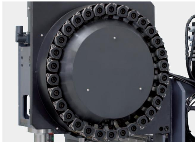
**Werkzeugmagazin.** Ist mit 30 Werkzeugplätzen ausgestattet. Bei der Version mit 24.000 U/min hat die Spindel eine HSK-A40 Aufnahme.
