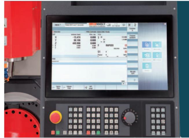
**Sinumerik 840D sl inkl. Shopmill.** Die Sinumerik 840D sl inkl. Shopmill ist ein universelles und flexibles CNC-System und bietet freie Konturprogrammierung, Fräszyklen für komplexe Konturen, schnelles Bezugspunkt-Setzen mit Tastsystemen, Schwenken der Bearbeitungsebene, Zylindermantel-Bearbeitung, 3D-Werkzeugkorrektur, schnelles Arbeiten durch kurze Satzverarbeitungszeit.
