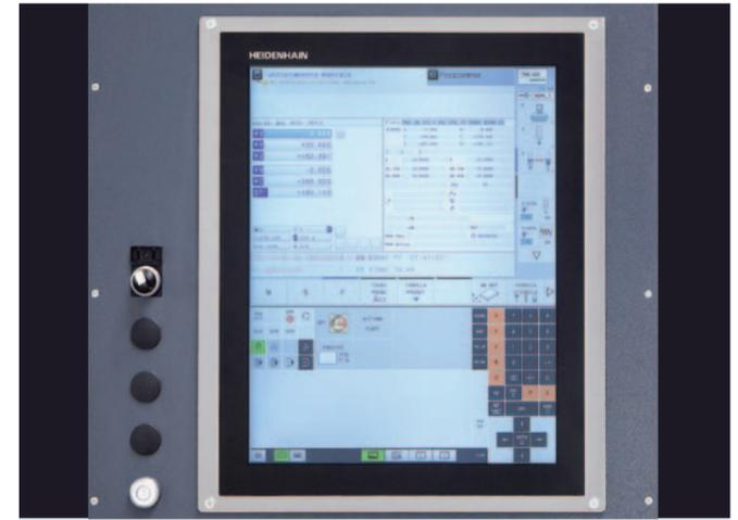
**Heidenhain TNC 620.** Die TNC 620 ist eine kompakte, vielseitige Bahnsteuerung für bis zu fünf gesteuerten Achsen. Mit ihrem flexiblen Bedienkonzept – werkstatorientierte Programmierbarkeit im HEIDENHAIN-Klartext-Dialog oder externe Programmierung – und ihrem Leistungsumfang ist sie optimal für den Einsatz an den EMCO Fräszentren ausgelegt.
