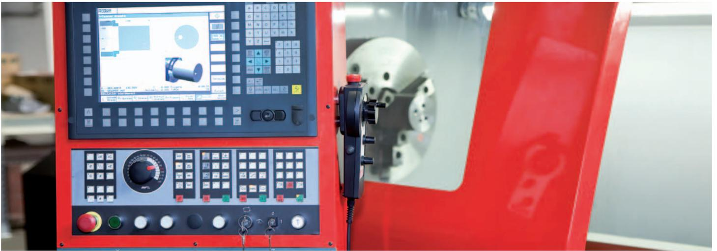
Siemens Steuerung „Sinumerik 840D sl - Shop Turn - Manuelle Maschine“ (inkl. Siemens-Zyklen und -Funktionen) und dem digitalen Antriebssystem Siemens „Sinamics S 120“: Das leistungsstarke CNC-System Sinumerik 840D sl für anspruchsvolle Lösungen ist effizient in Programmierung, Installation, Inbetriebnahme und Aufbautechnik, innovativ in NC-Funktionalität, Kommunikation, Bedienung und Offenheit.
