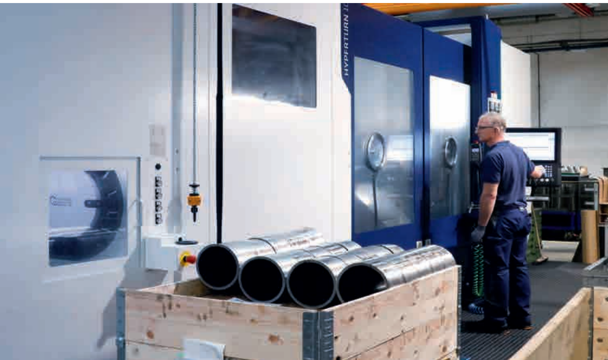
HYPERTURN 100 Centro di tornitura Powermill per la lavorazione completa di pezzi complessi.
