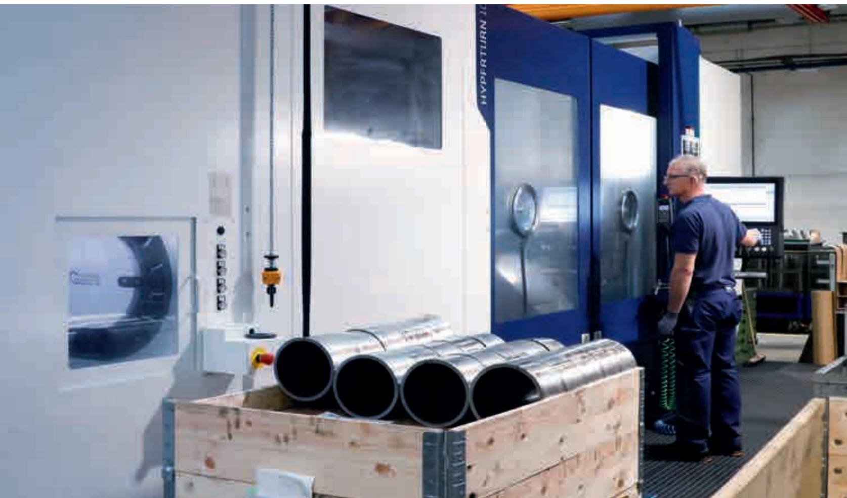
Centre de tournage et de fraisage HYPERTURN 100 Powermill pour l'usinage complet de pièces complexes.
