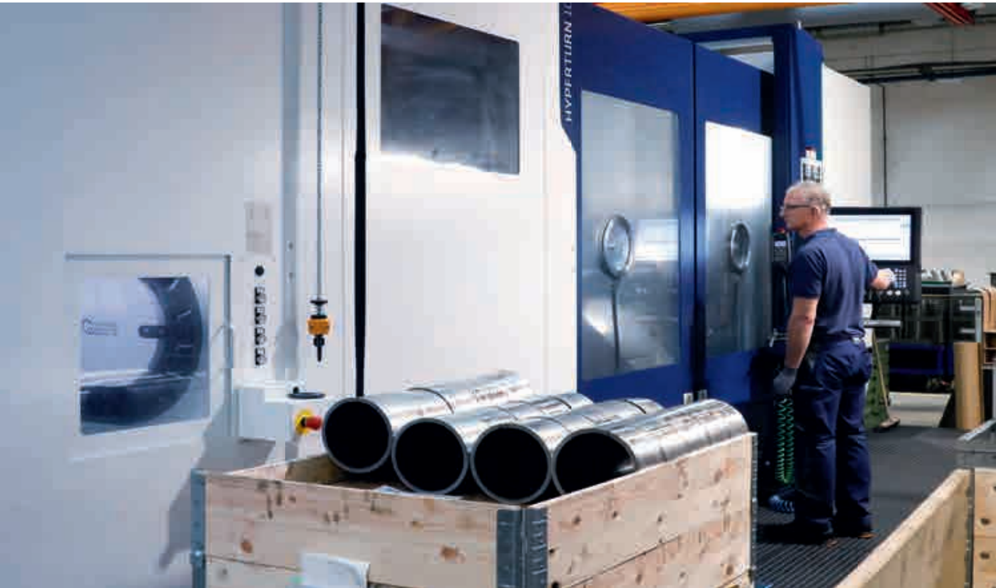
Dreh-Fräszenrum HYPERTURN 100 Powermill zur Komplettbearbeitung von komplexen Werkstücken.
