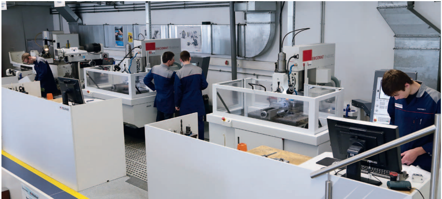
Zwei neue FB-600 MC Universalfräsmaschinen mit jeweils einer Siemens 828D und einer Heidenhain TNC 620-Steuerung ergänzen seit September 2016 das Ausbildungszentrum bei Haidlmair.
