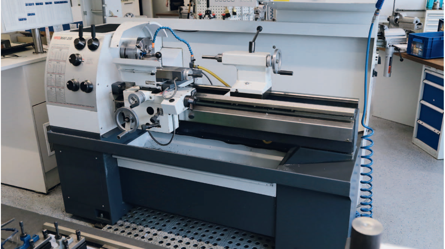
Die ebenfalls neuen Emcomat-20 D Universaldrehmaschinen mit Positionsanzeige für Bett-, Plan- und Oberschlitten – farblich optimal auf Haidlmair abgestimmt.
