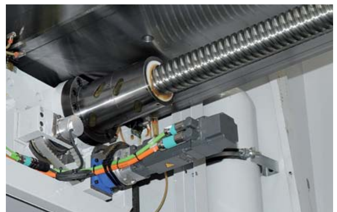
Il sistema MECOF WonderB.R.A. è un sistema a controllo numerico brevettato per la compensazione della flessione dello slittone
