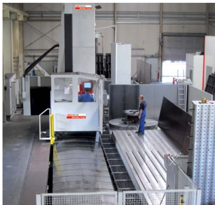
L'asse della macchina utensile a montante mobile di notevole precisione installata presso la MSB Maschinenbau Schmitt/Rhoen misura 14000 mm
