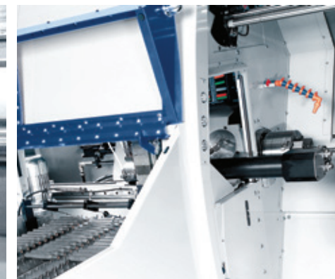
Chargement entièrement automatique des arbres. Alimentation par bande, déchargement via le dispositif de collecte des pièces finies.
