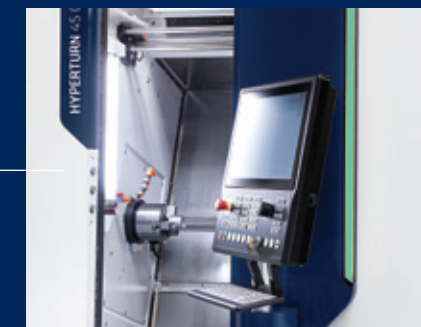
LAMPE D'ÉTAT LED. L'affichage d'état multicolore indique à l'opérateur les statuts individuels de la machine.
