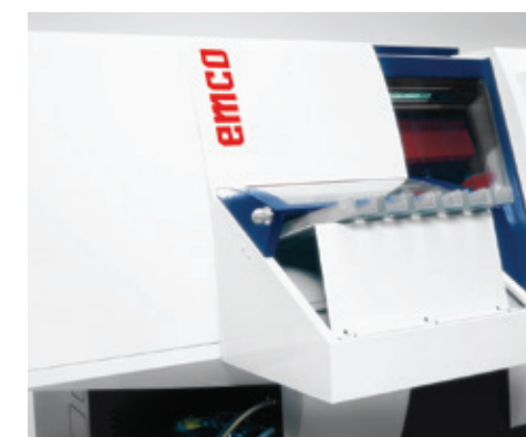
Zsuwnie wejściowe do ładowania rotacyjno-symetrycznych półfabrykatów. Czujnik monitoruje dostępność półfabrykatów dla każdej zsuwni wejściowej.
