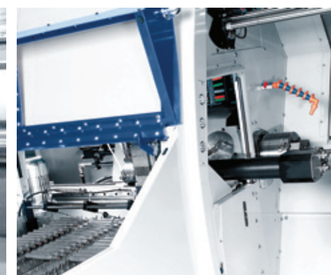
W pełni automatyczny załadunek wałków. Zasilanie przez przenośnik taśmowy, odbiór przez separator obrabianych części.
