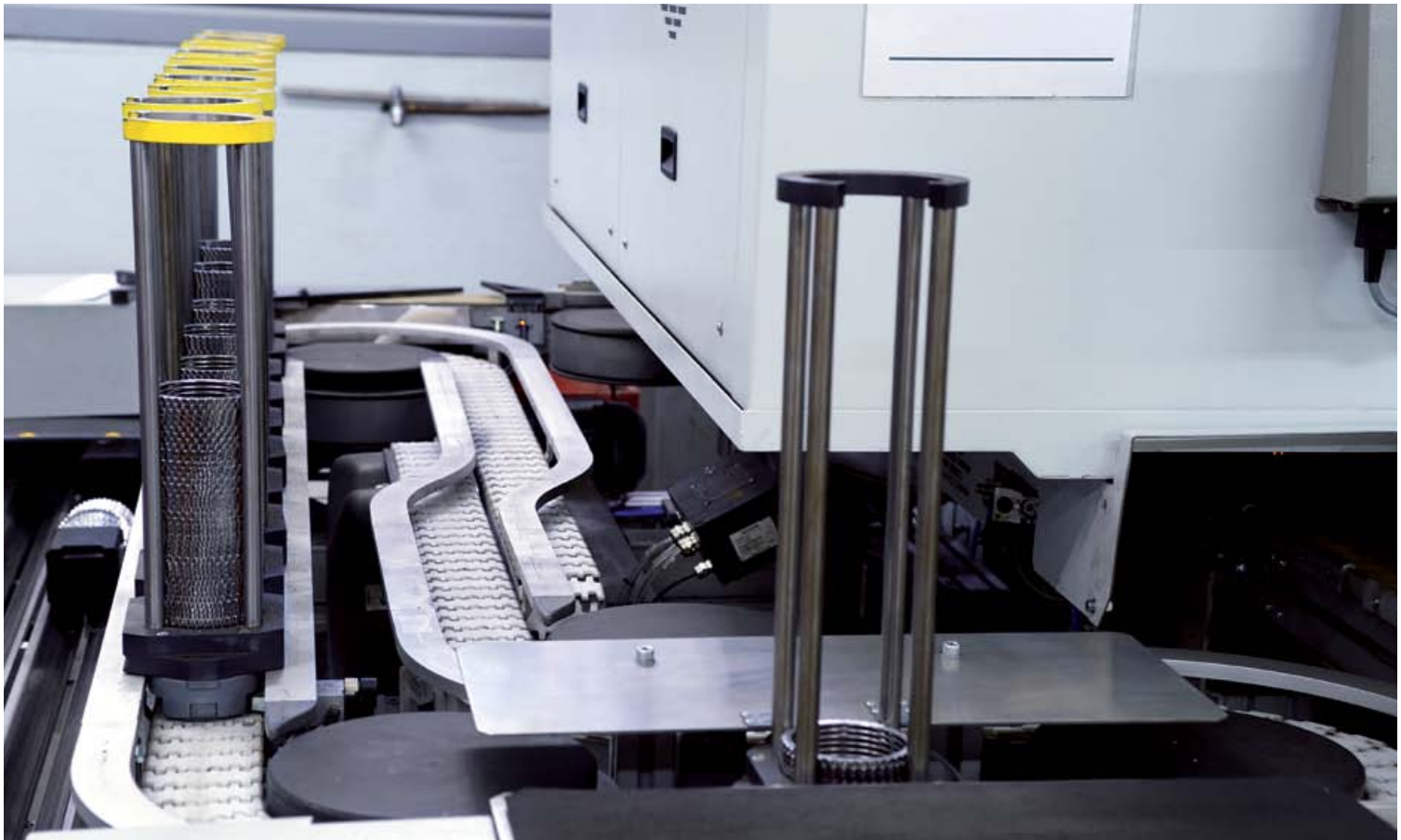
V přiváděcím a odváděcím zařízení integrovaném v soustruhu může být uloženo až 600 kotoučů spojky..
